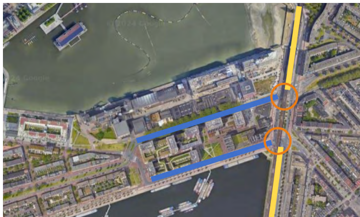
Figuur 6 De toevierwegen naar Katendrecht (geel), de twee VRI geregelde kruispunten (oranje cirkels) en ontsluitingswegen (blauw).
